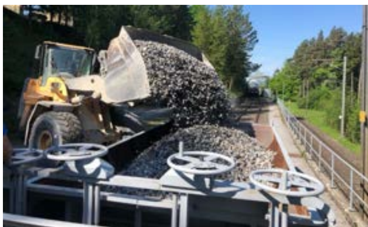
Ein Schotterwagen wird direkt im Schotterwerk beladen.
