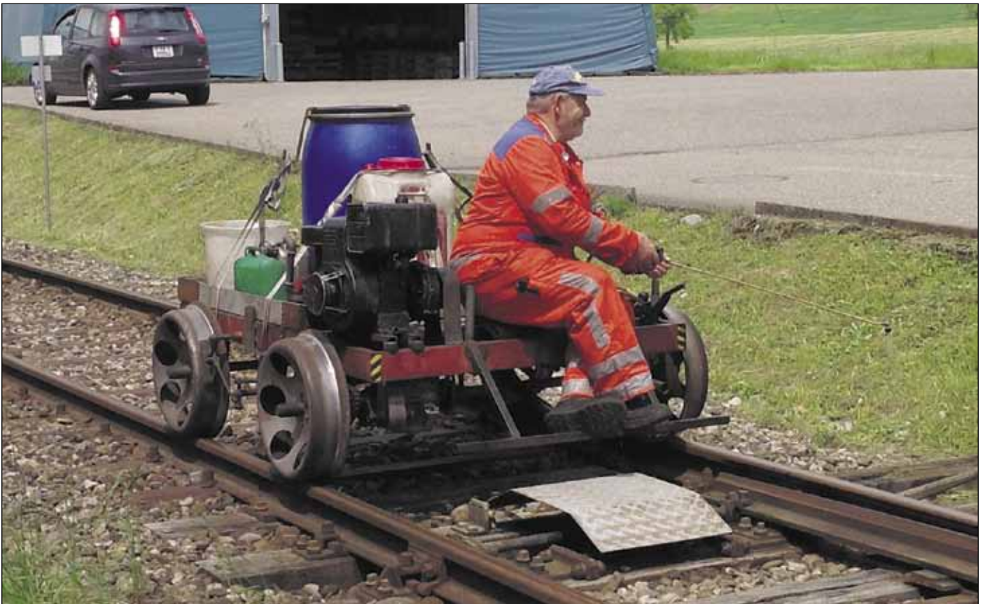
Infrastrukturmitarbeiter Sepp Hodel beim Kleinunterhalt in Büron am 15. Mai 2013. Zum Einsatz kam ein nicht alltägliches Fahrzeug, nämlich die Draisine Dm 1/2 «Luise», die 1981 bei der ST durch die Motorisierung eines alten Rollwagens entstand.
